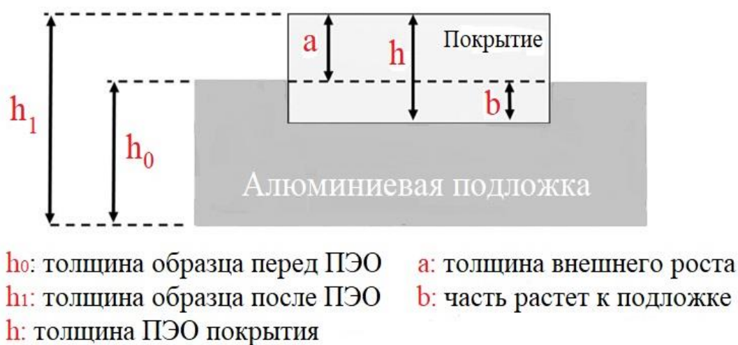
Рисунок 2 – Принципиальная схема, объясняющая формирование покрытия ПЭО на подложке из Al 1060 [40].
