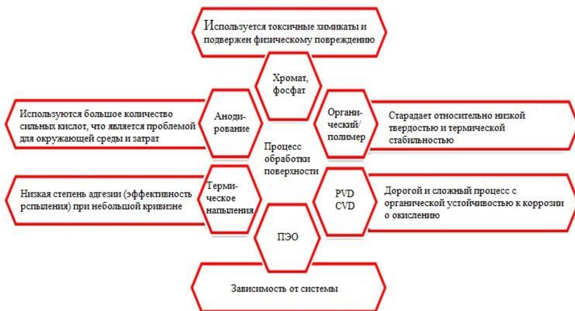
Рисунок 1 – Сравнение распространенных методов обработки поверхности, ограничение для клапанных металлов и сплавов [12].
